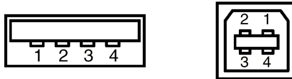
Abb. 2.2 Nummerierung der Anschlüsse an den Buchsen ((Pins.gif))
